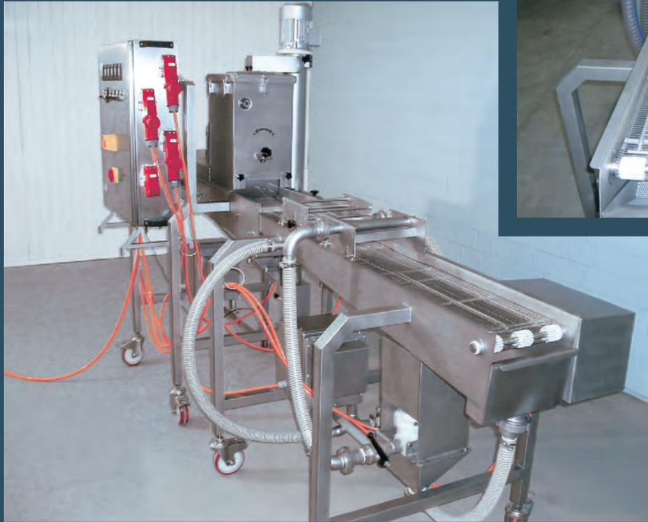
NASS- UND TROCKENPANIERANLAGE
